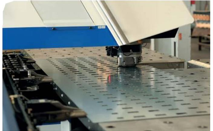
TopSolid' Sheetmetal 为每种刀具提供了加工策略，以优化冲压头在板材上的路径
